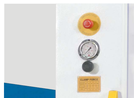
Регулируемое давление зажима верхней траверсы
