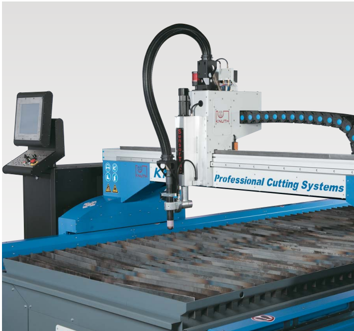
Режущая головка Hypertherm с THC контролем за высотой
