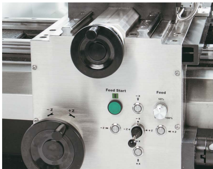
Сервопривод с кнопочным управлением Teach-in может установить конечный упор в соответствующую актуальную позицию
