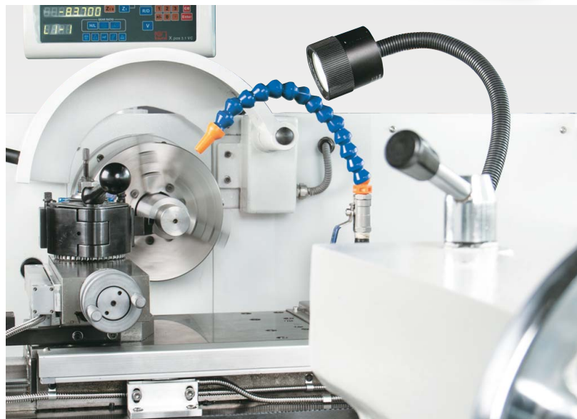
Поперечные салазки с механической подачей и поворотом
