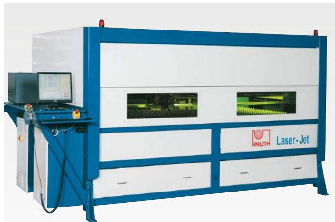
В связи с более короткой длиной волны волоконного лазера, раскрой осуществляется в закрытом корпусе. Его подвижная часть автоматически закрывается при начале раскроя и автоматически открывается после завершения операции резки, затем готовые детали могут быть изъяты из рабочей зоны.
