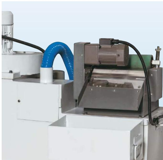
Система очистки и отвода охлаждающей жидкости (опция) уровень температуры стабильным
