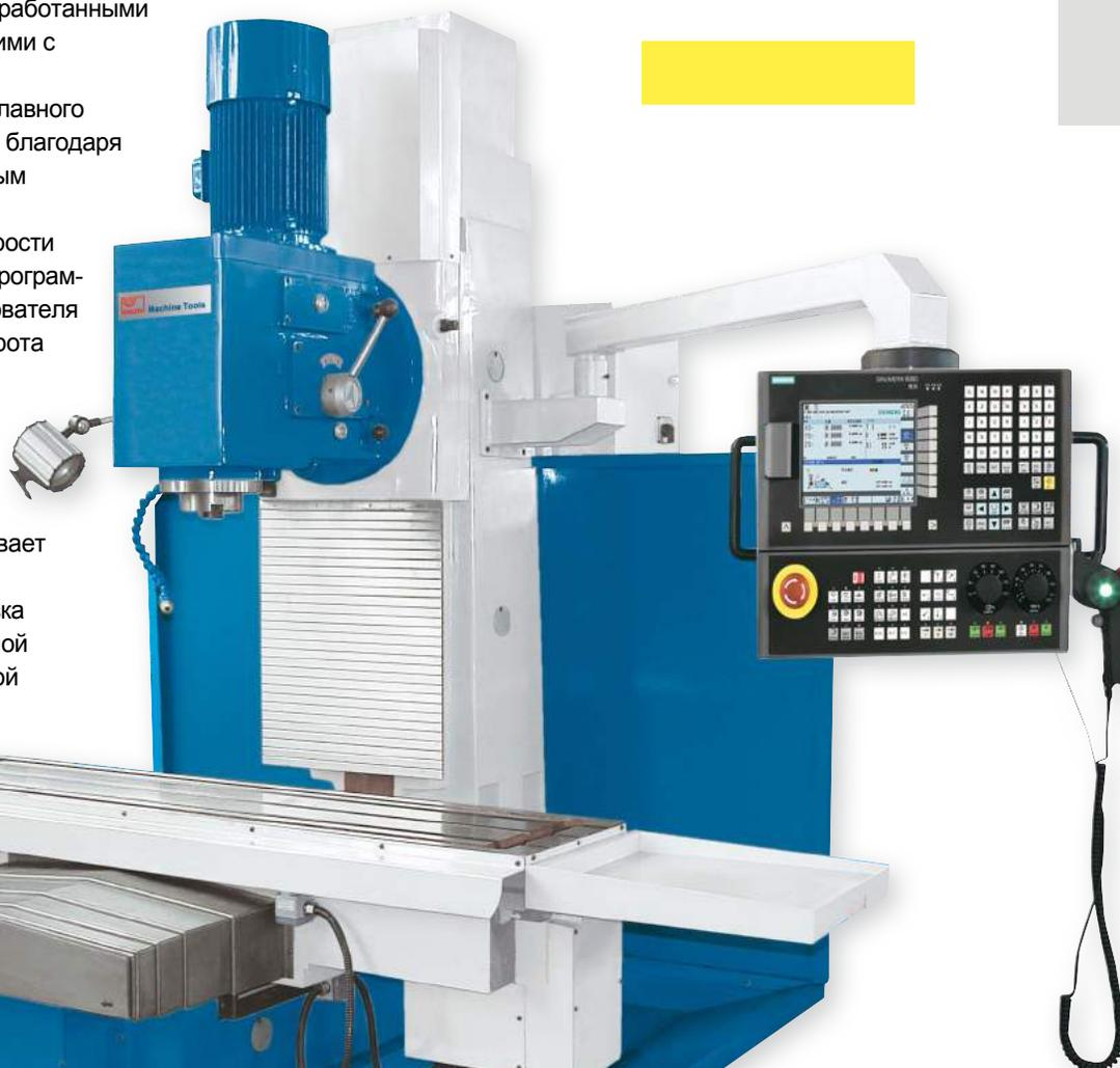
**Стандартные комплект.:** Siemens 808 D ЧПУ, электронный маховичёк, поддон для стружки, автомат. система центр. смазки, СОЖ, освещение рабочей зоны, прижимная штанга, сервисный инструмент, руководство по программированию и эксплуатации
