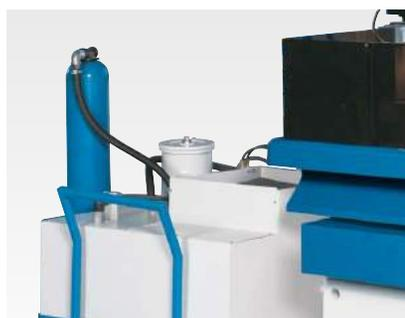
Ёмкость с диэлектриком и система фильтров
