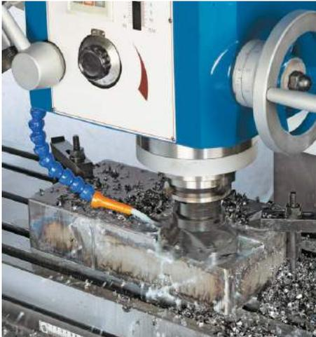
Фрезерование плоской пов. режущей головкой
