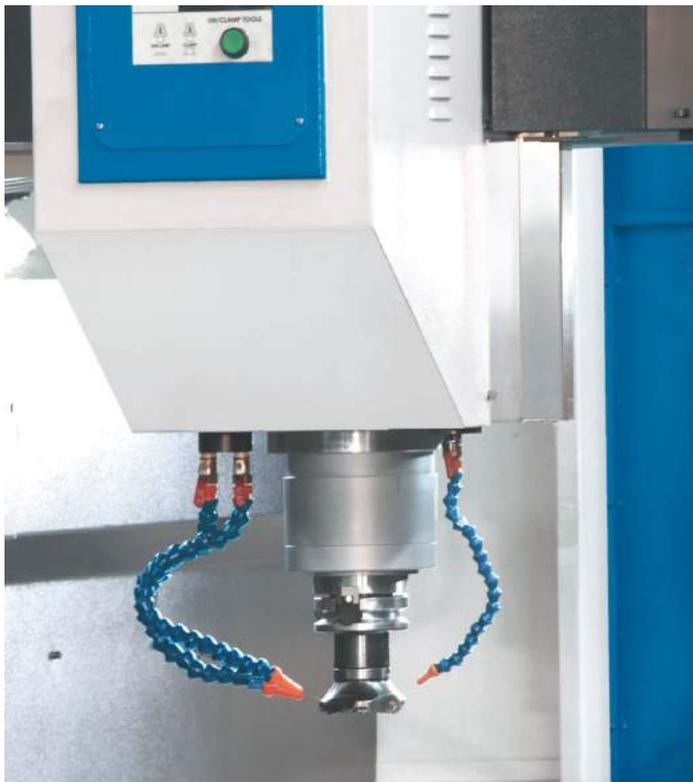
Зажим шпинделя с режущей головкой
