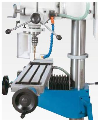
Поворотная фрезерная головка (л/пр) Регулир. по высоте рабочий стол
