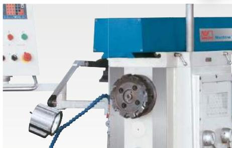
Горизонтальное фрезерование, также с использованием серги
