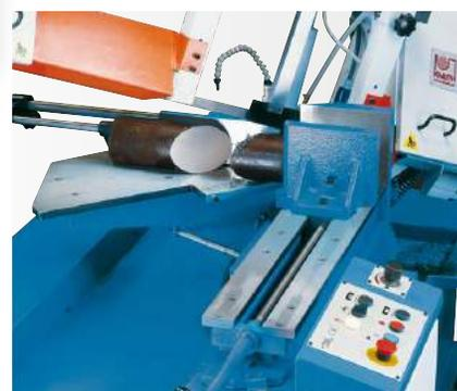
**Стандартные принадлежности:** зажим заготовки, система СОЖ, продольный упор, рольганг 1,2 м (только HB 320 BS), руководство по эксплуатации.
