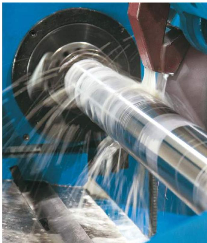
Мокрое шлифование вращающейся заготовки
