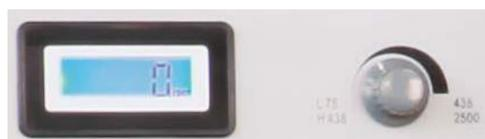
Бесступенчатое регулирование частоты вращения в 2 диапазонах
