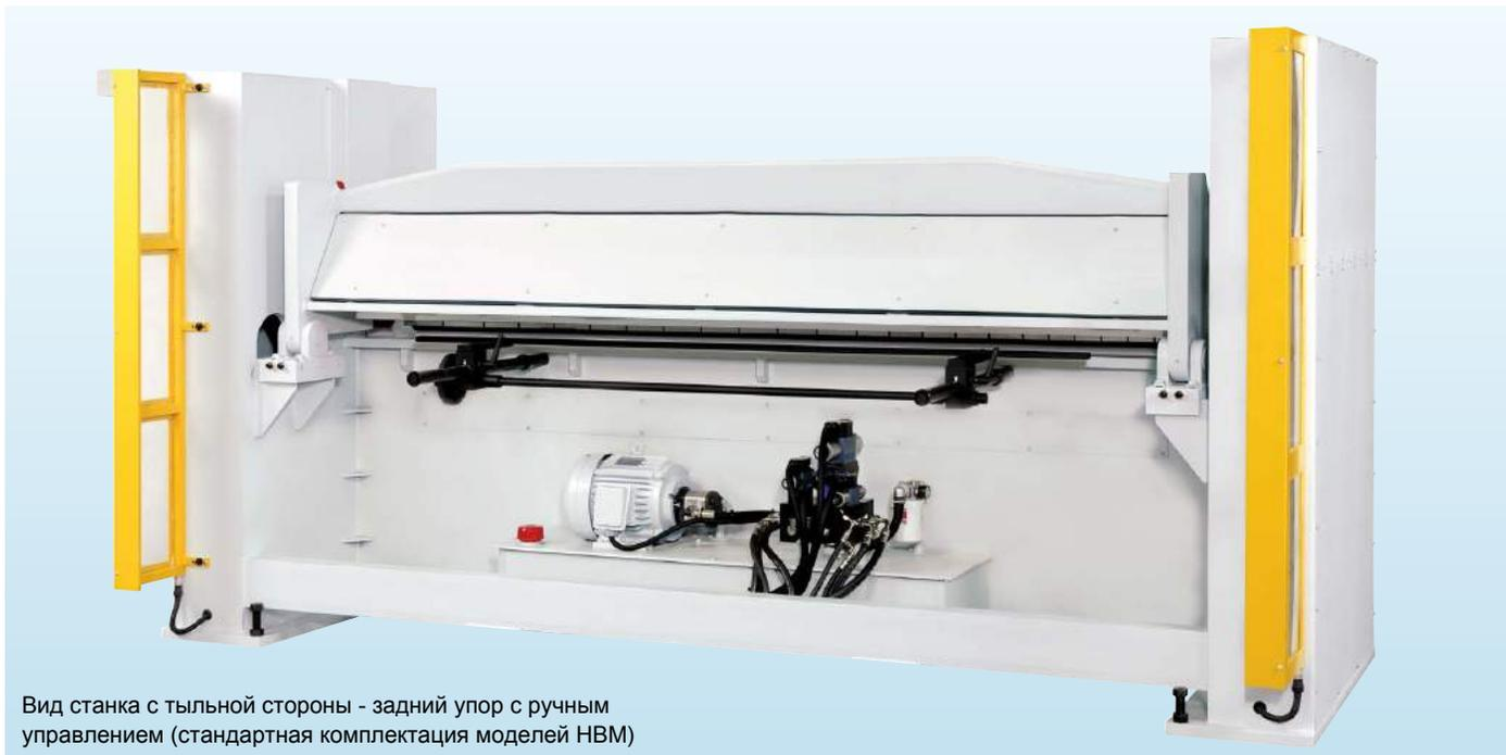
Вид станка с тыльной стороны - задний упор с ручным управлением (стандартная комплектация моделей HBM)
