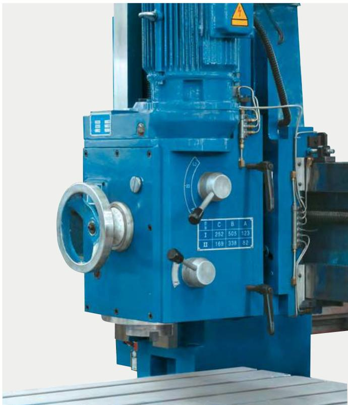
Точная подача фрезерной головки с ручным управлением, быстрый ход с электроприводом
