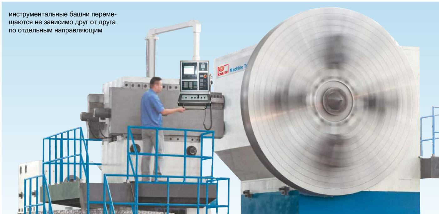
**Стандартные комплектующие:** ЧПУ Siemens 802 D SL, 4-кулачк. патрон для крепления на планшайбе 3200 мм, защита от стружки, освещение раб. зоны, обслуж. инструмент, руков. по эксплуатации
