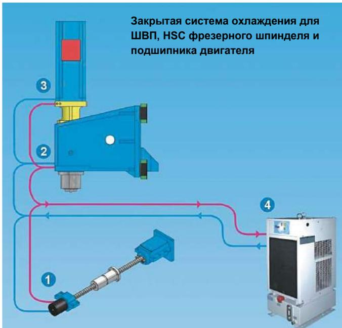
1. ШВП с внутр. охлаждением для предотвращения их от перегрева при сверхскоростном режиме обработки
