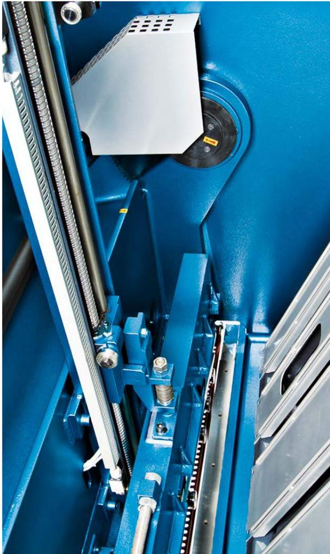
Задняя сторона станка с моторизованным задним упором и встроенными ШВП
