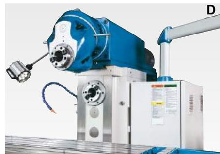
Универсальная поворотная головка и горизонтальный шпиндель
