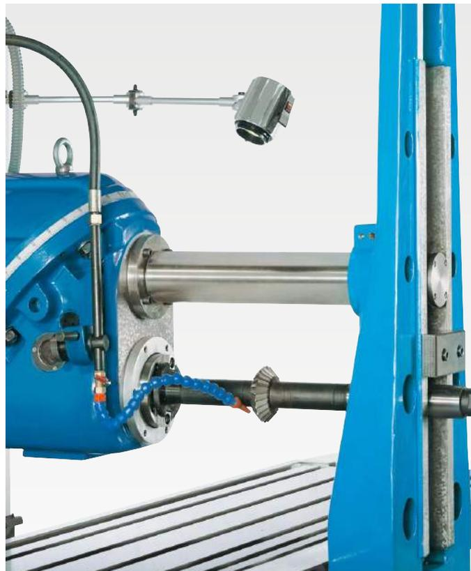
Горизонтальный зажим фрезерной оправки, которым серийно укомплектован станок KB 2100 обеспечивает исключительную стабильность и позволяет использовать все преимущества продольно-фрезерной конструкции станка также и при обработке с применением длинных фрезерных оправок.
