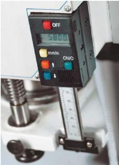
Цифровая индикация глубины сверления
