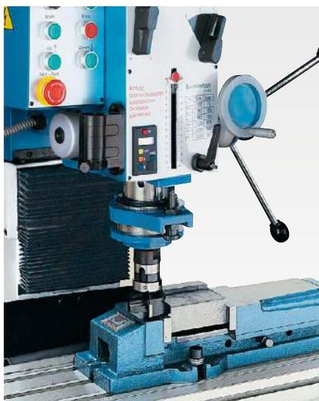
Фрезерование резцовой фрезерной головкой
