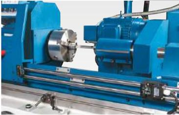
Диаметр шлифования до 200 мм
