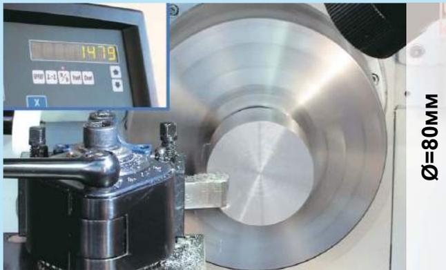
... с помощью автоматически регулируемой частоты вращения шпинделя ...
