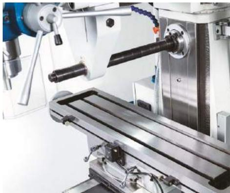
Верхняя траверса, оснащенная серьгой, позволяет надежно зажимать длинные фрезерные оправки
