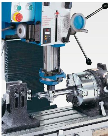
Фрезерование шлицов с делительной головкой
