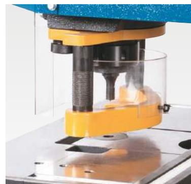
Устройство просечной штамповки с большим рабочим столом
