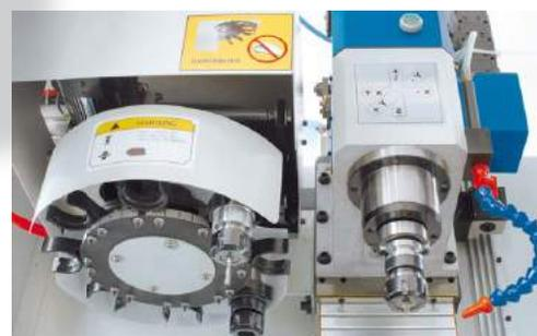
Автоматизация повышает производительность - 8-поз. сменщик для MAS BT 30 инструментов
