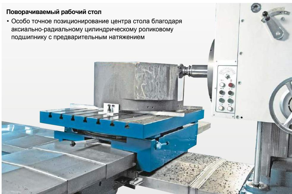
**Стандартные принадлежности:** ЧПУ Siemens 828 D, шариковые винты, центральная система смазки, фундаментные болты, электронный маховик, RS 232 интерфейс, программное обеспечение, руководство по программированию и эксплуатации
