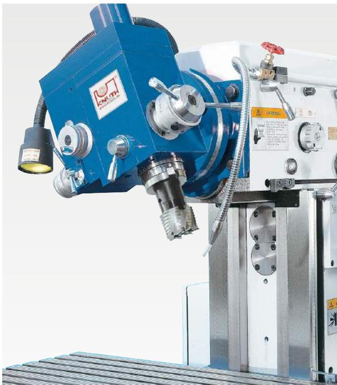
Фрезерная головка  $\pm 90^\circ$  с ходом пиноли 60 мм и ее автом. подачей
