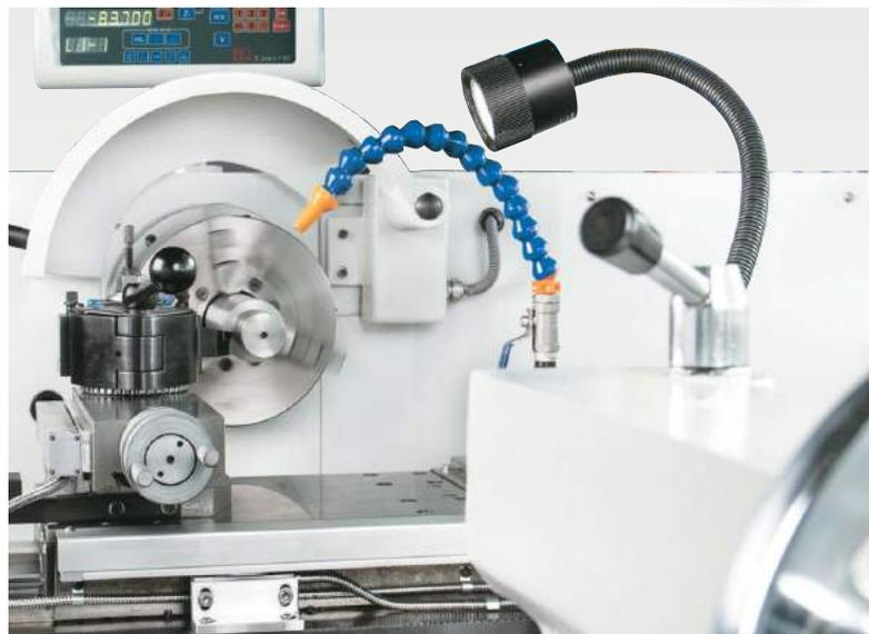
Поперечные салазки с механической подачей и поворотом
