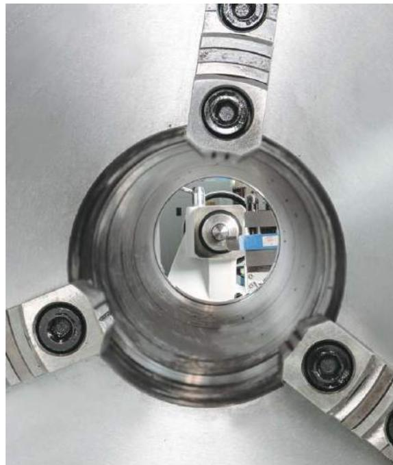
Внутренний Ø шпинделя от 135 до 225 мм
