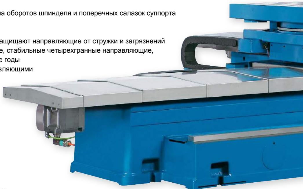
Горизонтально-расточной станок с ЧПУ
