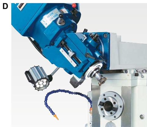
Фрезерная головка с углом поворота на 45°
